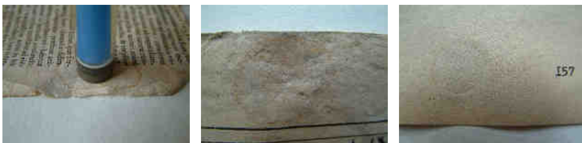
3. pav. pH matavimo plokščiuoju elektrodu vietoje atsiradusių patakų dydis ir forma priklauso nuo popieriaus savybių (K. Lukoševičienės nuotraukos)
