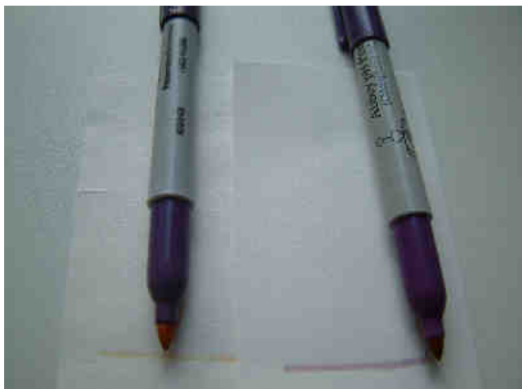
1 pav. pH pieštukas rūgščiam popieriuje brėžia geltoną liniją, o neutraliame ar šarminiame – levandų spalvos (K. Lukoševičienės nuotrauka)
